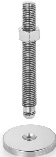
Pie compuesto por dos unidades separadas (base y esparrago), con alta capacidad de carga, este pie se sostiene con la presión vertical del peso de la máquina. Absorbe un movimiento de 20°. Conjunto de dos partes separadas. Opcionalmente se puede servir con una goma antideslizante de caucho compacto de dureza Shore A70.
